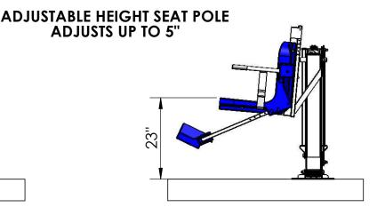
ADJUSTED ALL THE WAY UP THE LOADING HEIGHT IS 23"
