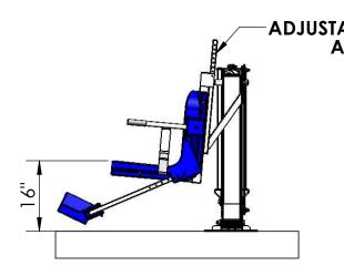
\*ADJUSTED ALL THE WAY DOWN THE LOADING HEIGHT IS 16"
